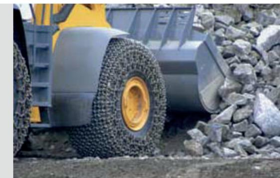
Malhas de rodagem especialmente desenvolvidas e forjadas para excelente proteção dos pneus em ambientes de extrema severidade.
