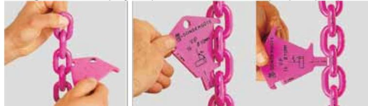
Os componentes VIP são produzidos com uma proteção de superfície *duplex*. Isto compreende dois processos: pré-tratamento e revestimento pink. Com este procedimento de duas etapas, alcança-se uma proteção de superfície relativamente melhor em comparação com a zincagem. Sob encomenda, aplicamos o revestimento CORRUD DS – vinte vezes mais resistente à ferrugem do que o processo de zincagem.
